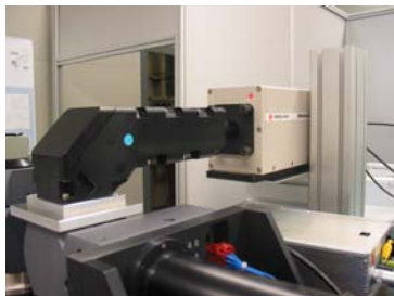
Integration des CPC-System in eine Anlage zum Laserstrahlbohren
